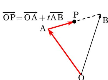
左の図における点Pの位置は  $t = \frac{1}{2}$  のときのものである。 $t=0$  のとき、点Pは点Aと一致し、 $t=1$  のとき、点Pは点Bと一致する。 $0 \leq t \leq 1$  の範囲で  $t$  が様々な値をとると、点Pは2点A, Bの間を埋め尽くし、線分ABを描くことになる。
