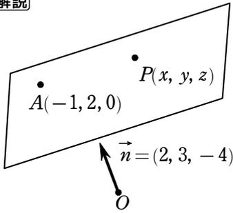
左図のように、求める平面上の任意の点を  $P(x, y, z)$  とすると、点  $P$  が求める平面上のどこにあったとしても  $\vec{n} \cdot \vec{AP} = 0 \dots \textcircled{1}$  が成り立ちます。
